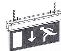
3. Підключити мережний провід (Ø6 мм) до клемної колодки відповідно до зазначеної полярності.
