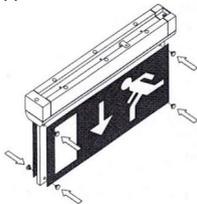
2. Установить светильник на стену или потолок .
