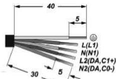
3. Підключити мережеві дроти до колодки на задній стінці корпусу відповідно до зазначеної полярності. При використанні регульованого драйвера, керуючі дроти підключаються строго з дотриманням полярності, зазначеної в маркуванні.
