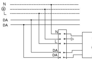
4. Шамшырақты 1-10V системасы арқылы реттеулі қуат беруші сымға жалғау схемасы.
