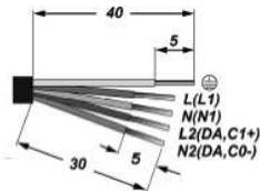
3. Подключить сетевые провода к колодке на задней стенке корпуса в соответствии с указанной полярностью. При использовании регулируемого драйвера, управляющие провода подключаются строго с соблюдением полярности, указанной в маркировке.
