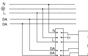
4. Схема поключенія світильника до мережі живлення з регулюванням по системі 1-10V.
